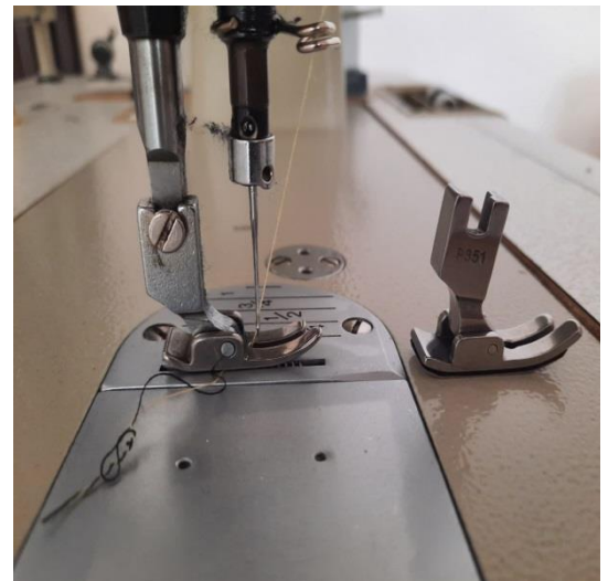
б) лапка с датчиком изменения нагрузки
